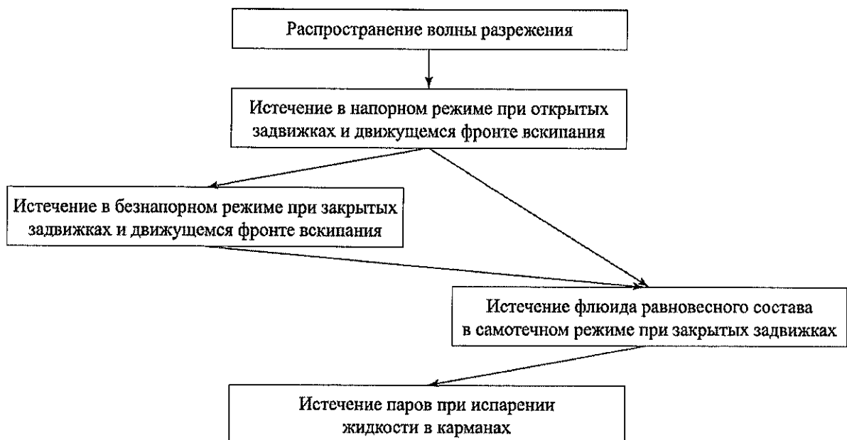
Рис. 2. Стадии истечения нестабильной жидкости при гильотинном разрыве КП/ПП
